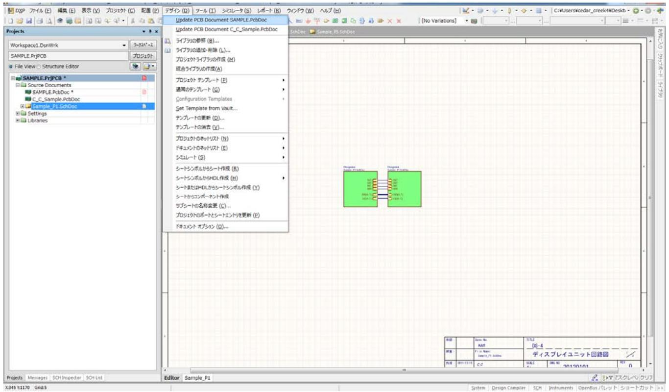
回路図のデータから PCB データに部品情報を伝達
