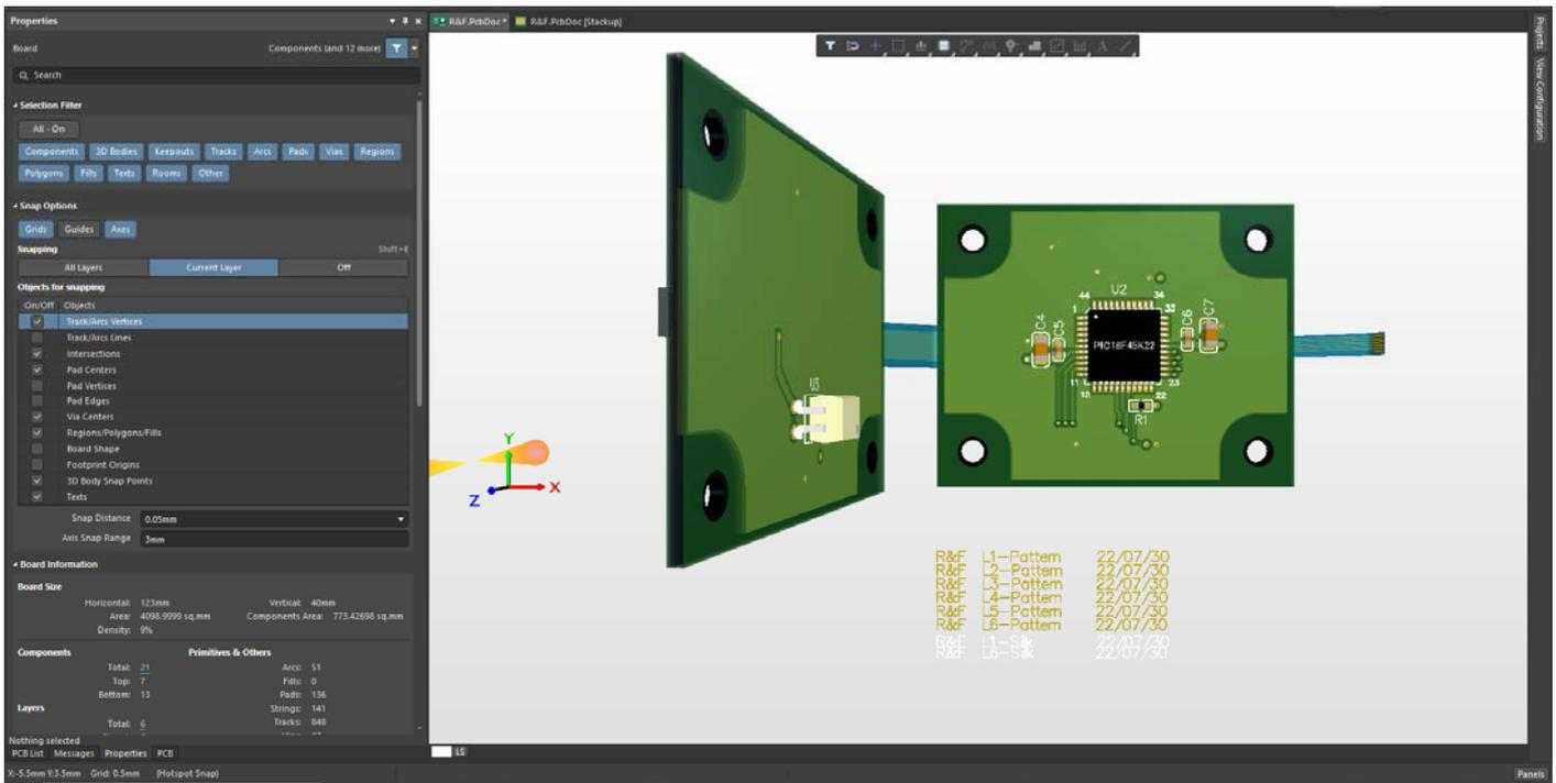
1枚の基板だけ 3D を固定する。
